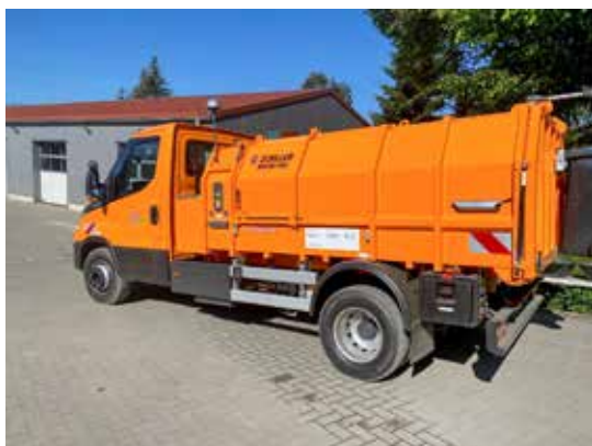
Die neue Müllpresse besteht aus einem Iveco E-Daily mit einem Zöller Micro HG-Aufbau.
