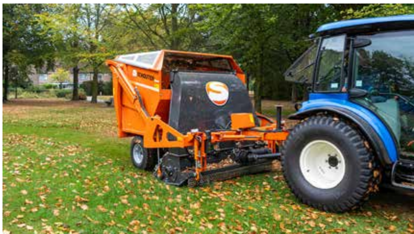
Den Schouten-Mäh-Ladewagen gibt es jetzt in der größeren Arbeitsbreite von 1,80 m und mit Insektenschutz.
