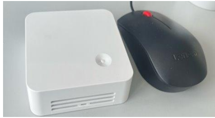
ABBILDUNG 4 Klimamessstation, die Temperatur- und Feuchtigkeitsinformationen in 15-Minutenabständen via LoRaWAN-Funknetz an die sMArt City Mannheim Datenplattform gesendet hat.
